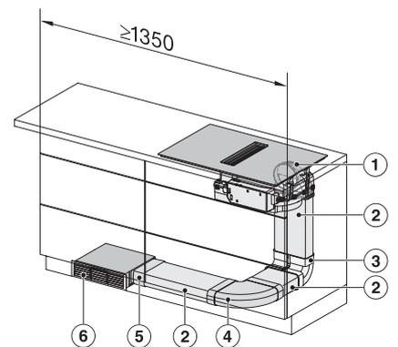
KMDA7676FL, KMDA7876FL – Einbauvariante 5 Umluft – Skizze
